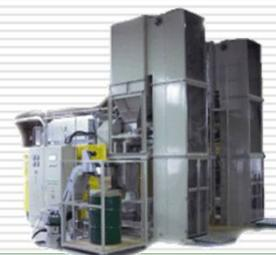
脱水銀化処理装置
